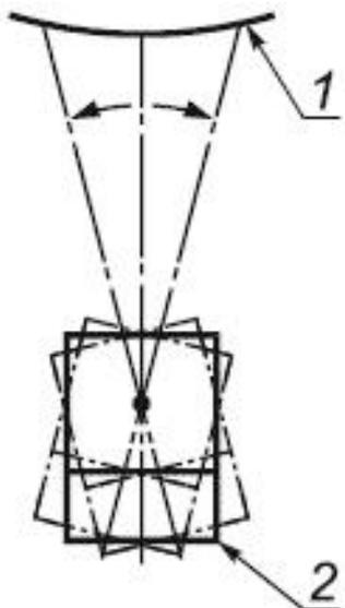
1 - несплошность (2.1.12)/дефект (2.1.15); 2 - наклонный преобразователь (2.5.1)
