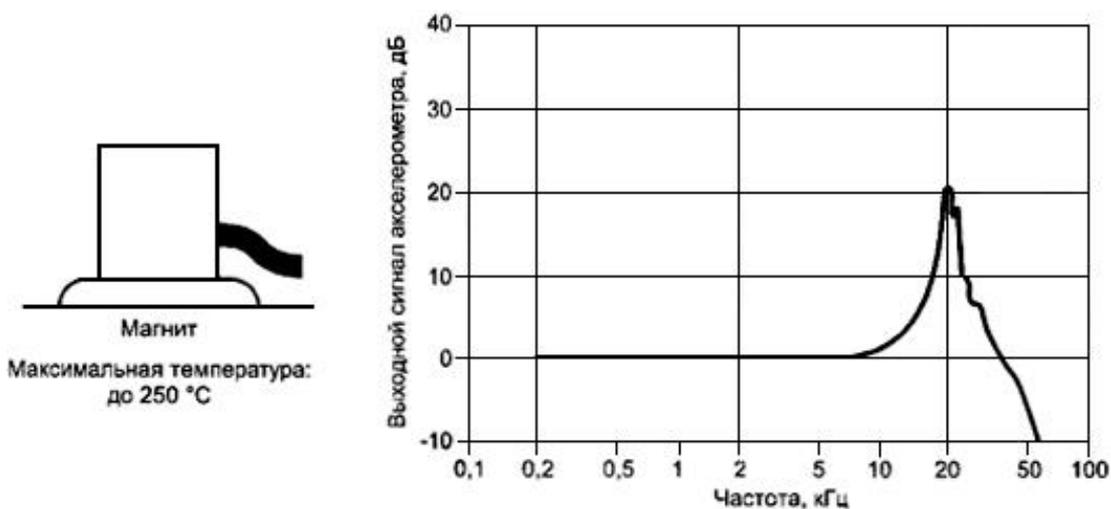
Рисунок 9 - Частичная частотная характеристика акселерометра на магните
