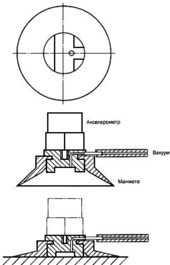
Рисунок 11 - Вакуумное крепление
