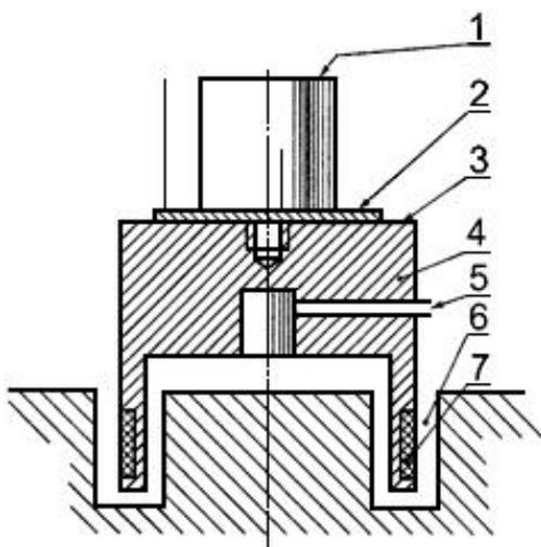
1 - акселерометр; 2 - образец материала поверхности; 3 - обработанная эталонная поверхность;
