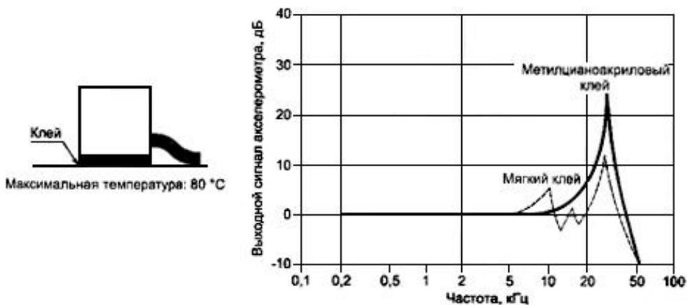
Рисунок 6 - Типичная частотная характеристика акселерометра при клеевом соединении
