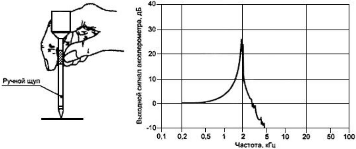
Рисунок 8 - Типичная частотная характеристика акселерометра с щупом
