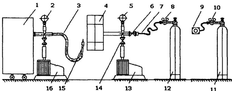
Рис. 5. Схема установки для контроля способом шупа:
