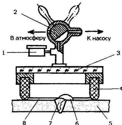
Рис. 8. Схема проведения контроля герметичности вакуумным пузырьковым способом:
