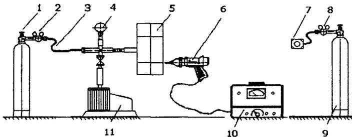
Рис. 7. Схема установки для контроля способом галогенного шупа:
