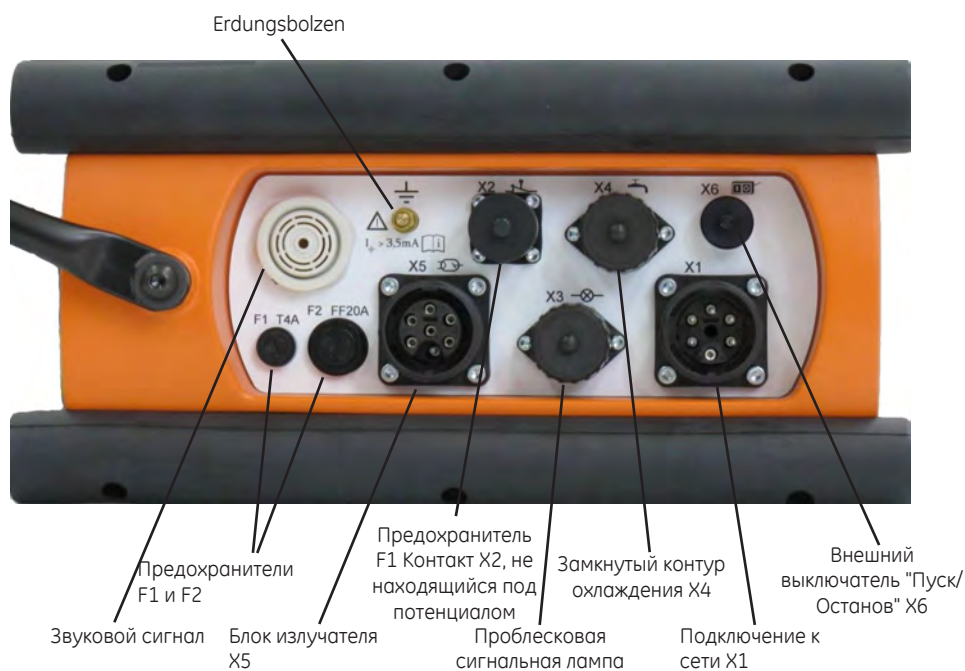
Рис. 5 - Утопленная панель штекерных разъемов прибора цифрового управления ERESKO MF4 (показано без кожуха и ручки)
