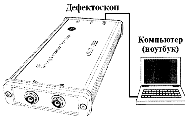
Рисунок 1 – Подключение электронного блока дефектоскопа к компьютеру
